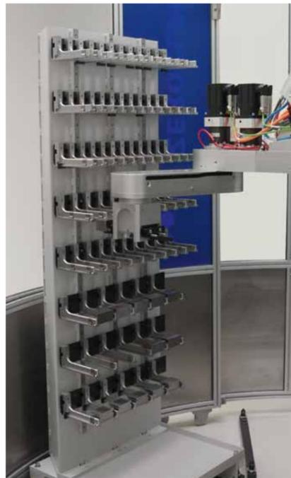
Produktiv fertigen rund um die Uhr: ZeroClamp konzipiert spezielle Roboter nach dem Scara-Prinzip, die aus individuell konfigurierten Werkstück- und Werkzeugspeichern Dreh- und Fräszentren be- und entladen.
