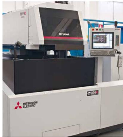
Fertigt Formeinsätze genau und kostengünstig: die Drahterodiermaschine MV2400R bei DTM in Badalona
