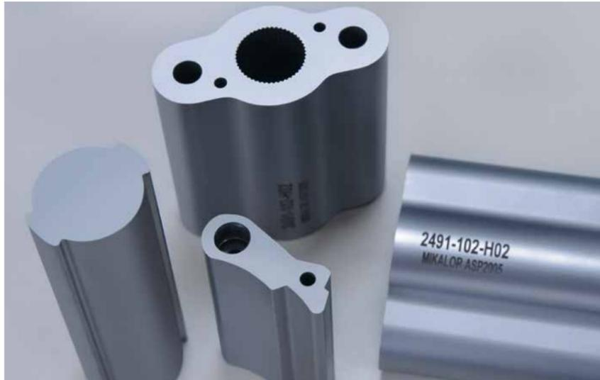
Genau und schnell: Mit wenigen Schnitten fertigt die Drahterodiermaschine MV1200R exakt auch kleinste Geometrien mit hoher Oberflächengüte in gehärteten Bauteilen.
