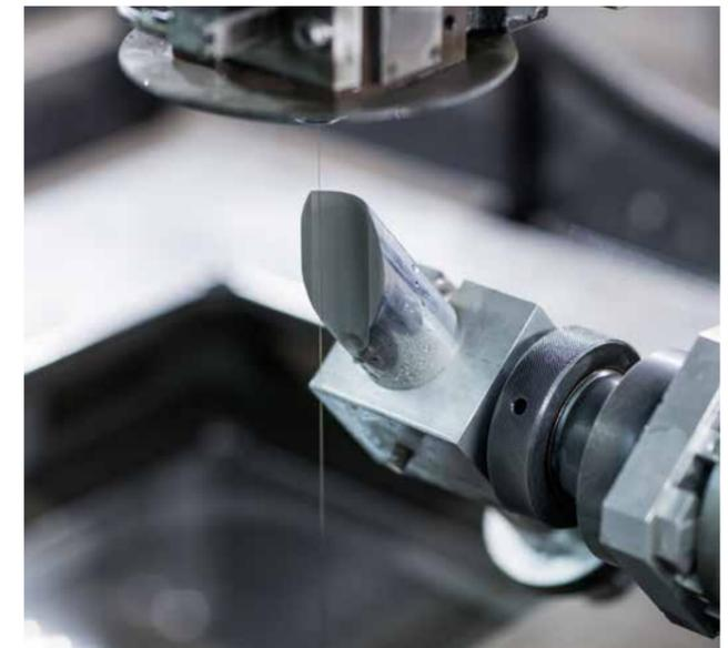
Präzise Profilierung auf der Indexierachse
