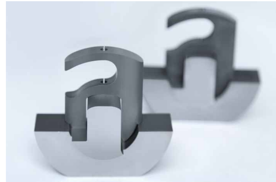
Quand il y a des contours complexes, l'électroérosion est la meilleure solution.
