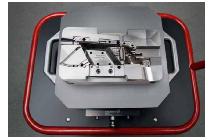
Insert pour un moule à 4 cavités (poignée encastrée)
