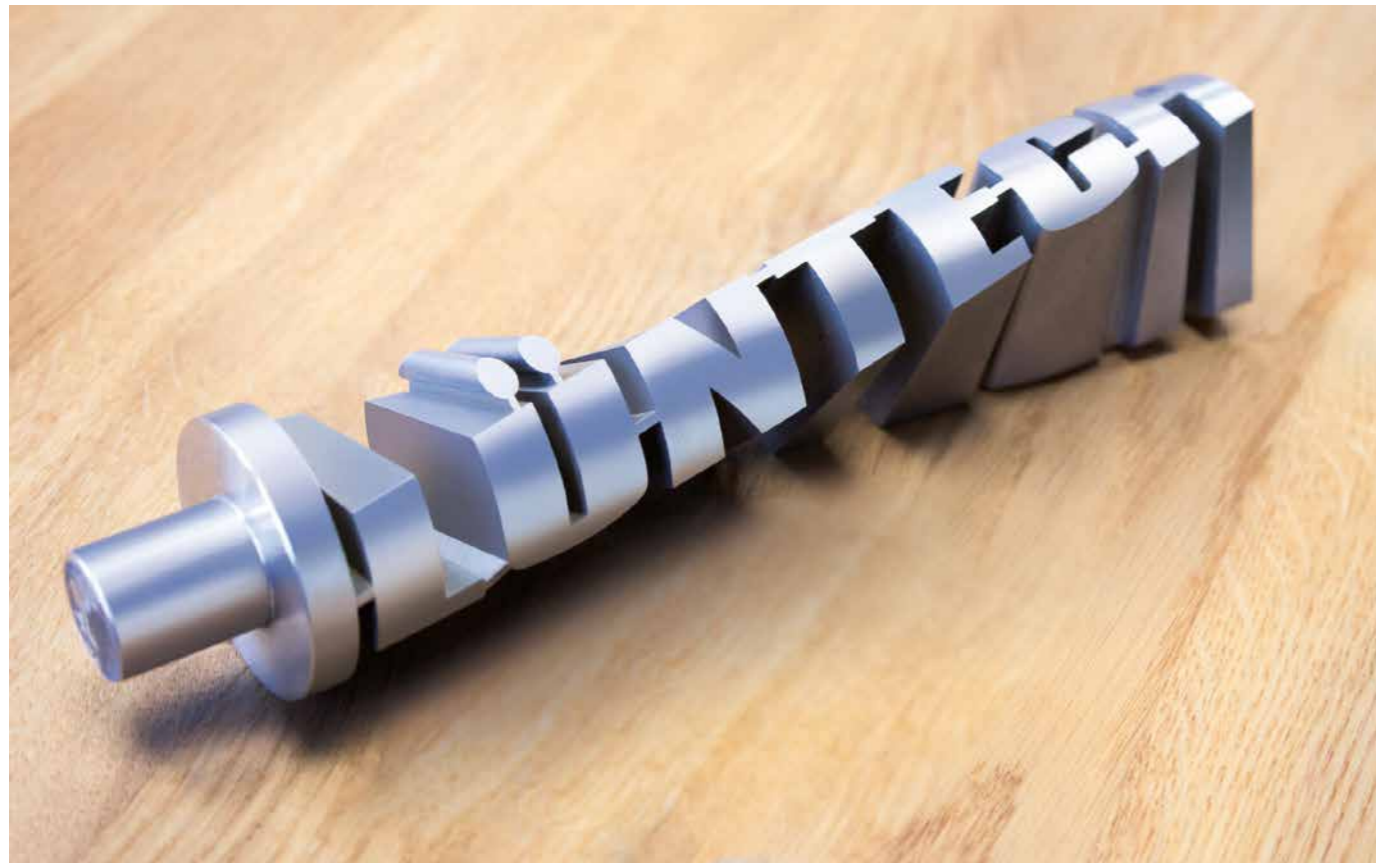
Inscription par électroérosion à rotation synchrone
