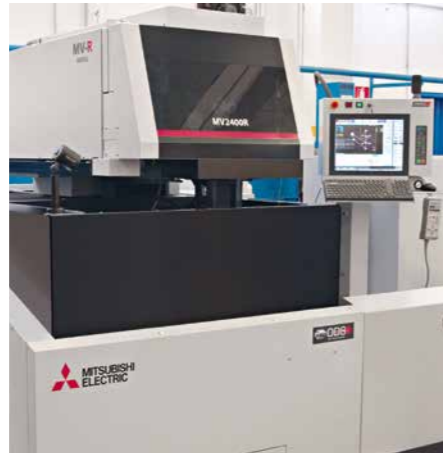
La machine d'électroérosion à fil MV2400R de DTM à Badalona produit des inserts de moules avec précision et à un bon rapport qualité-prix.
