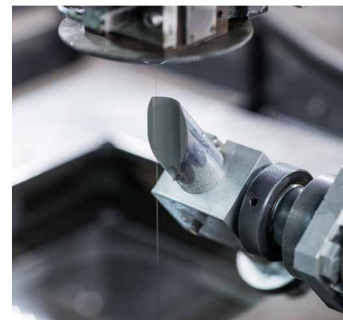
Profilage de précision sur l'axe d'indexation
