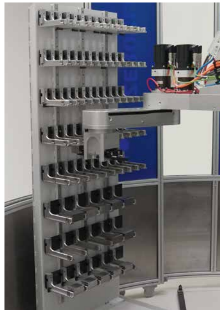
Productivité élevée 24 h sur 24 : ZeroClamp conçoit des robots spéciaux selon le principe de Scara afin de charger et décharger des centres de tournage à partir de pièces configurées individuellement et de magasins d'outils.
