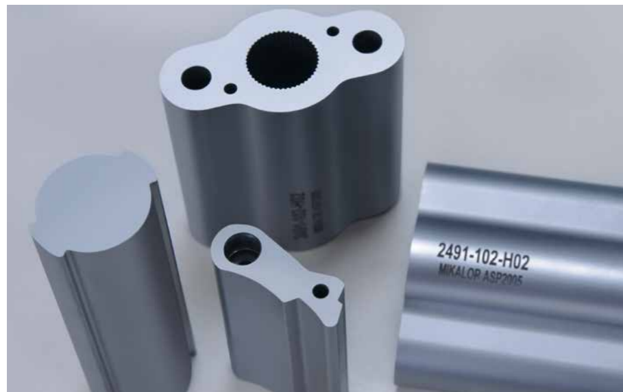
Con soli pochi tagli, la macchina EDM a filo MV1200R produce velocemente componenti temprati con superfici di alta qualità dalle sagome più disparate.
