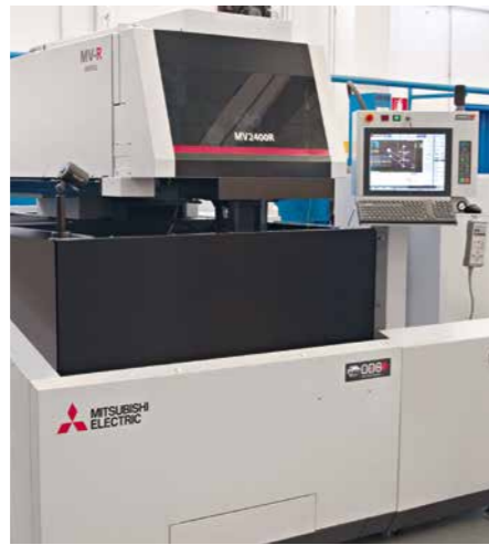
La macchina EDM a filo MV2400R della DTM di Badalona produce stampi con precisione e un'ottima qualità prezzo.
