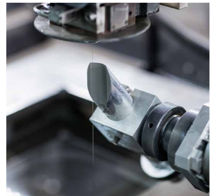
Precisatura di precisione su un asse indicizzato
