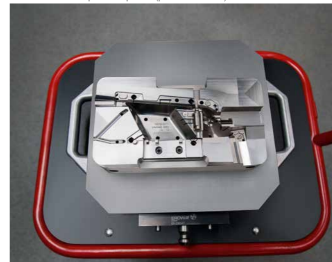
Cavità in uno stampo a 4 impronte (presa rientrante)
