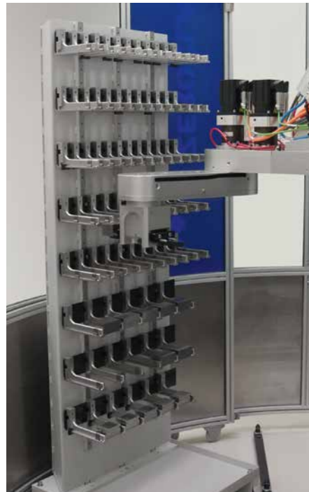
Alta produttività 24 ore su 24: La ZeroClamp progetta speciali robot basati sul principio SCARA che caricano e scaricano centri di tornitura e fresatura da pezzi configurati singolarmente e da utensili.
