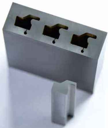
Une précision maximale est requise pour usiner les pièces de rechange des outils de poinçonnage et de découpe destinés à la production des pièces minuscules du secteur médical et des télécoms.
