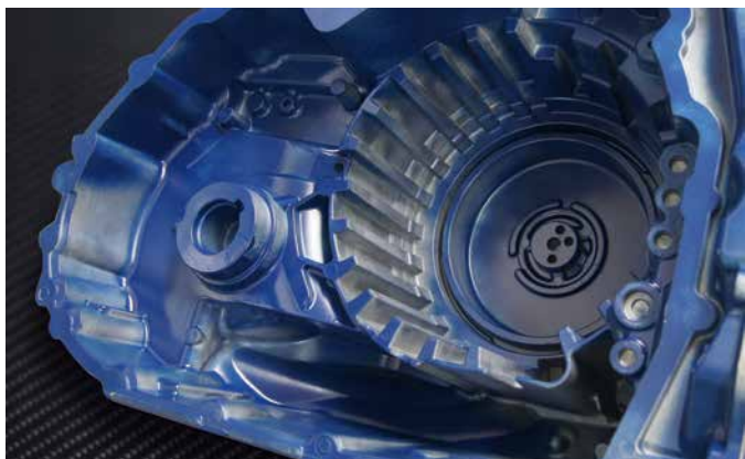
Exemple de grande pièce en aluminium assez complexe, ébavurée et nettoyée avec un outil provenant de la société basée à Cantù.
