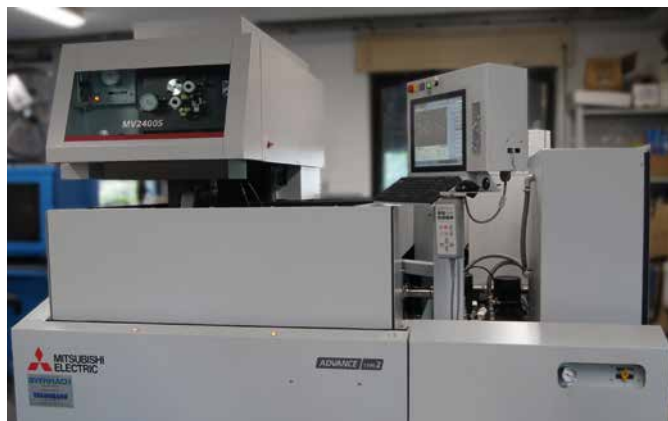
Dans l'atelier Farina Marco, la machine Mitsubishi Electric MV2400S est utilisée pour la production de poinçons et de matrices pour outils d'ébavurage.
