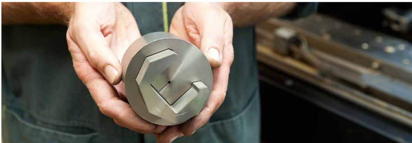
L'électroérosion à fil de haute précision sur Mitsubishi Electric MV1200R permet souvent de ne pas faire de polissage supplémentaire.
