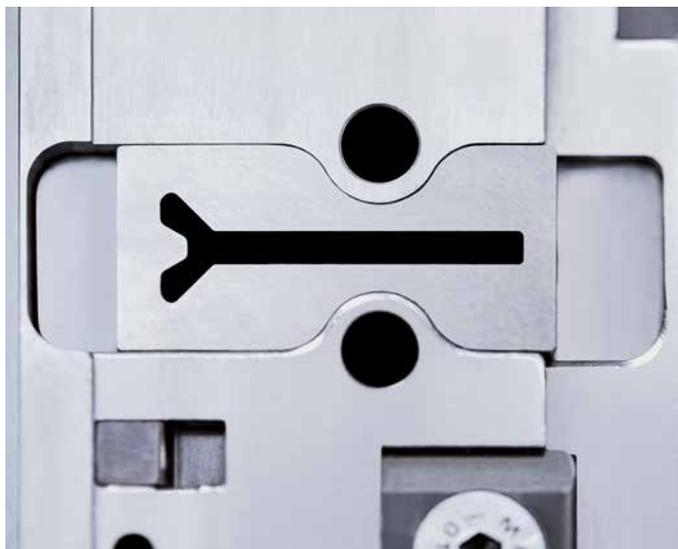
Matrice en carbure cémenté dans un outil de poinçonnage
