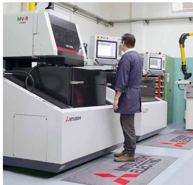
Confiant dans la technologie de pointe, Celoplás n'utilise que les systèmes d'électroérosion à fil de Mitsubishi Electric.
