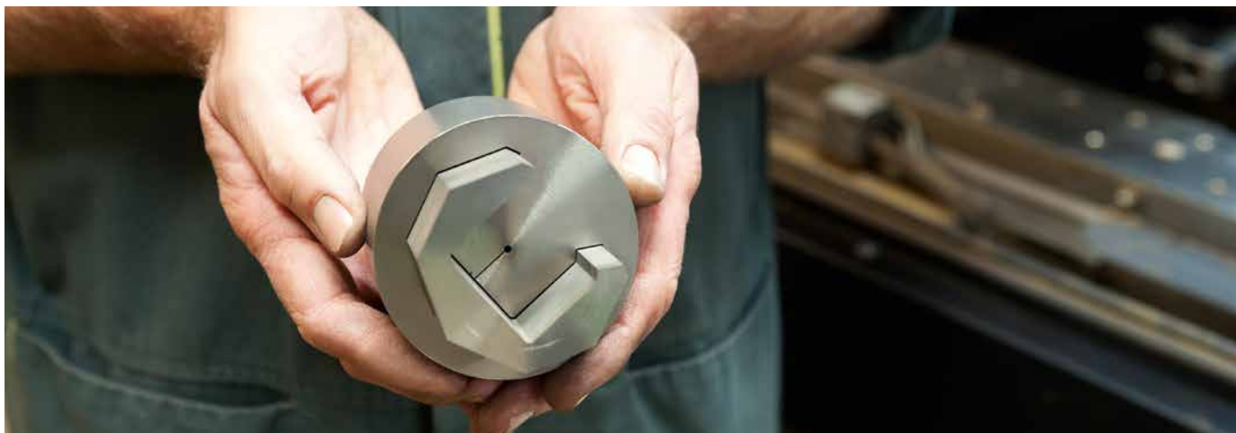
La macchina per l'elettroerosione a filo MV1200R di Mitsubishi Electric è talmente precisa da rendere spesso superflua la rettifica finale.
