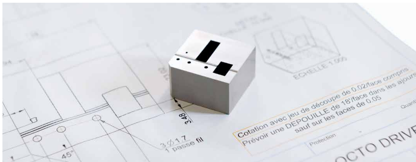
Alcuni componenti più piccoli vengono piazzati per essere elettroerosi a filo senza supervisione, producendo così lotti a basso costo.
