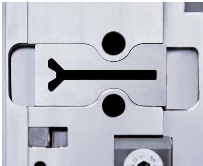
Uno stampo di carburo cementato in un componente di un punzone.
