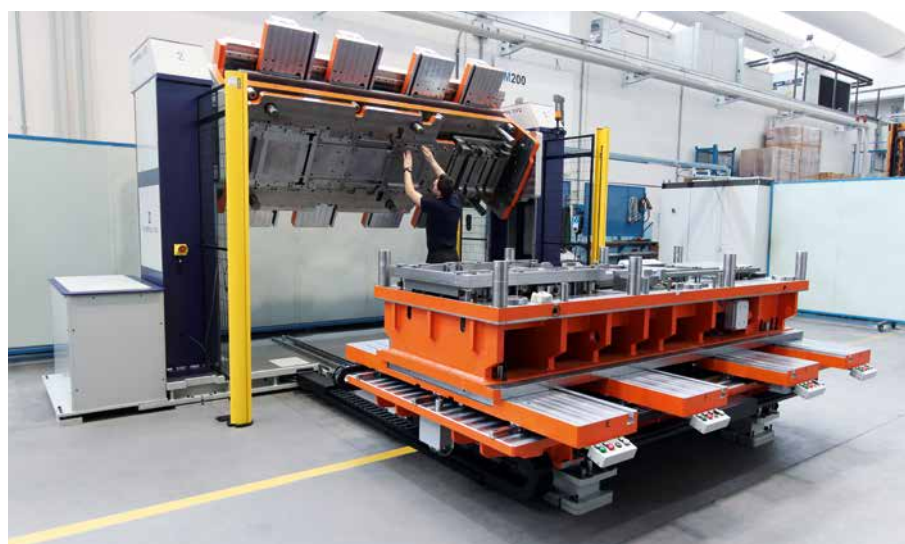
La macchina denominata “montastampi” è una invenzione di Universal1972, un vero e proprio fiore all'occhiello. Garantisce sicurezza nella movimentazione degli stampi
