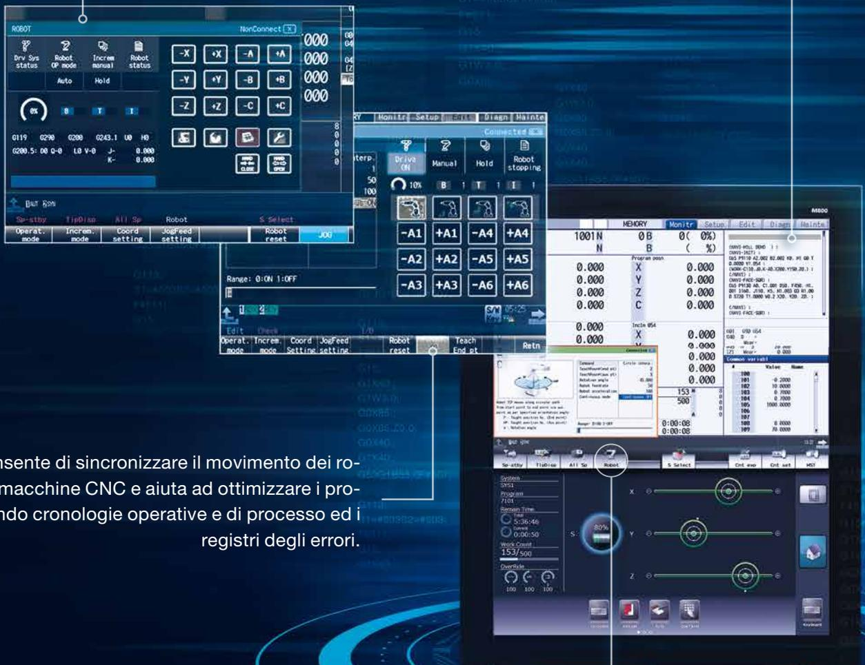
Il DRC consente di sincronizzare il movimento dei robot e delle macchine CNC e aiuta ad ottimizzare i processi fornendo cronologie operative e di processo ed i registri degli errori.
