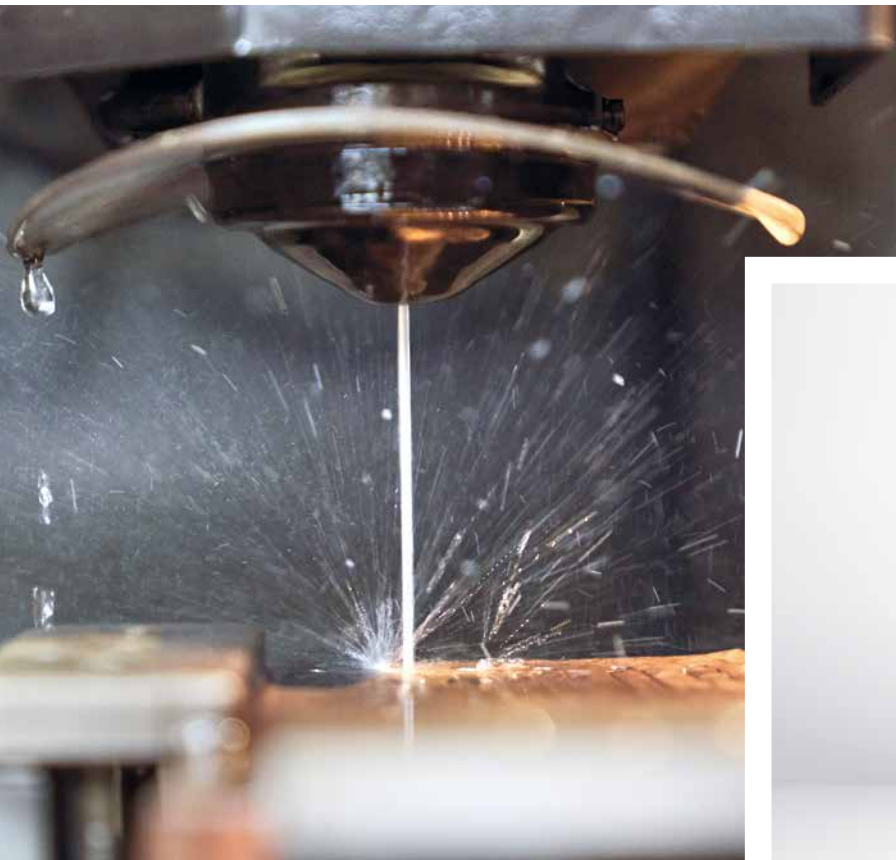
Pièce en érosion à fil due à sa résistance mécanique 60HRC
