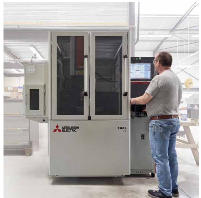
L'installation d'électroérosion par enfonçage Mitsubishi Electric EA8S mise en service en même temps que la MV1200R
