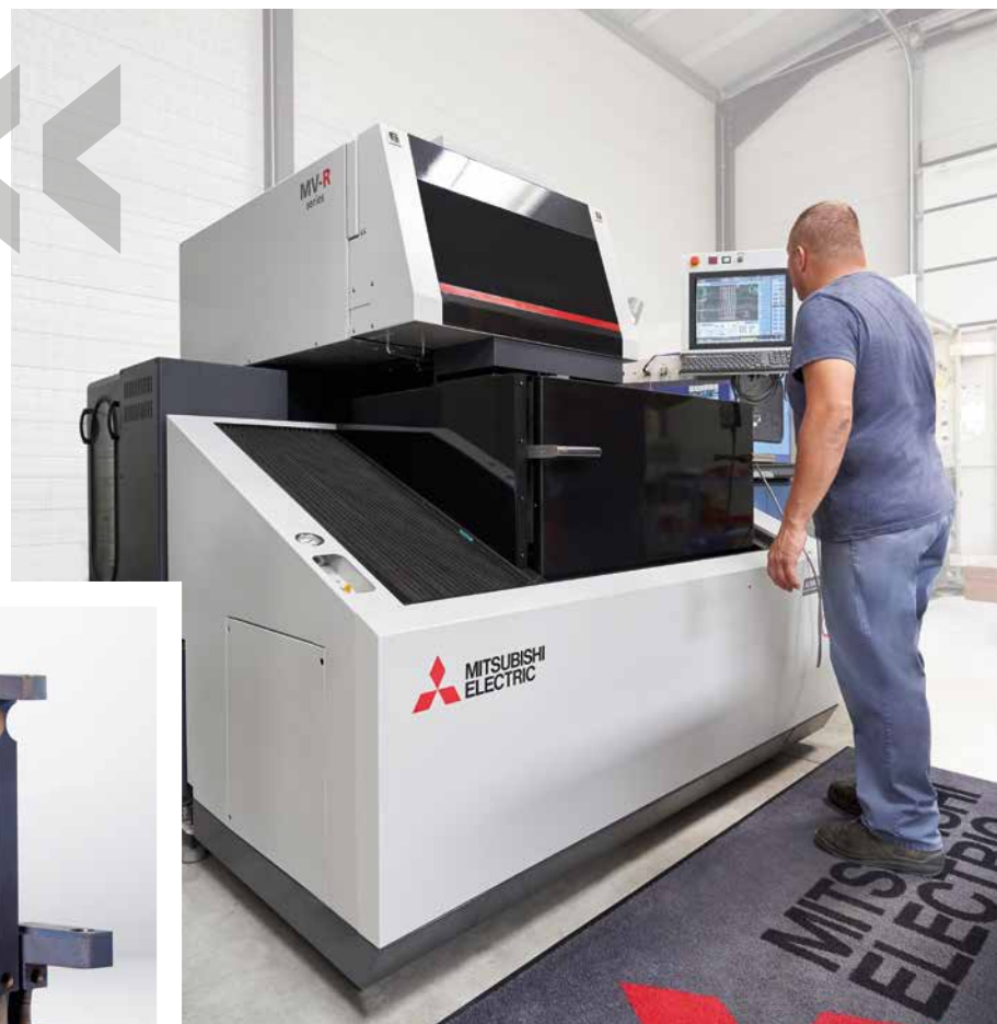
La machine d'électroérosion à fil MV1200R utilisée depuis trois ans chez AMB
