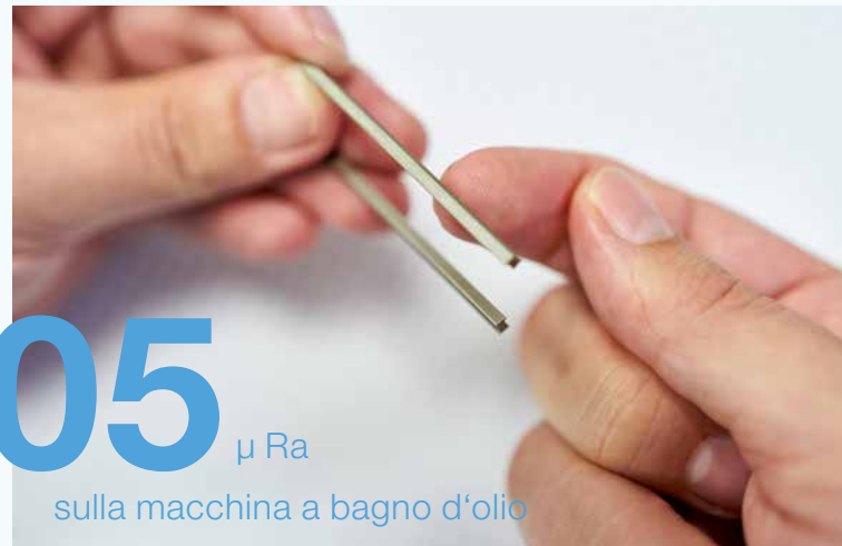
Falk Lange mostra la finitura superficiale di un punzone da taglio prodotto su una macchina ad elettroerosione a filo a bagno d'olio rispetto a quello prodotto su una macchina a bagno d'acqua.
