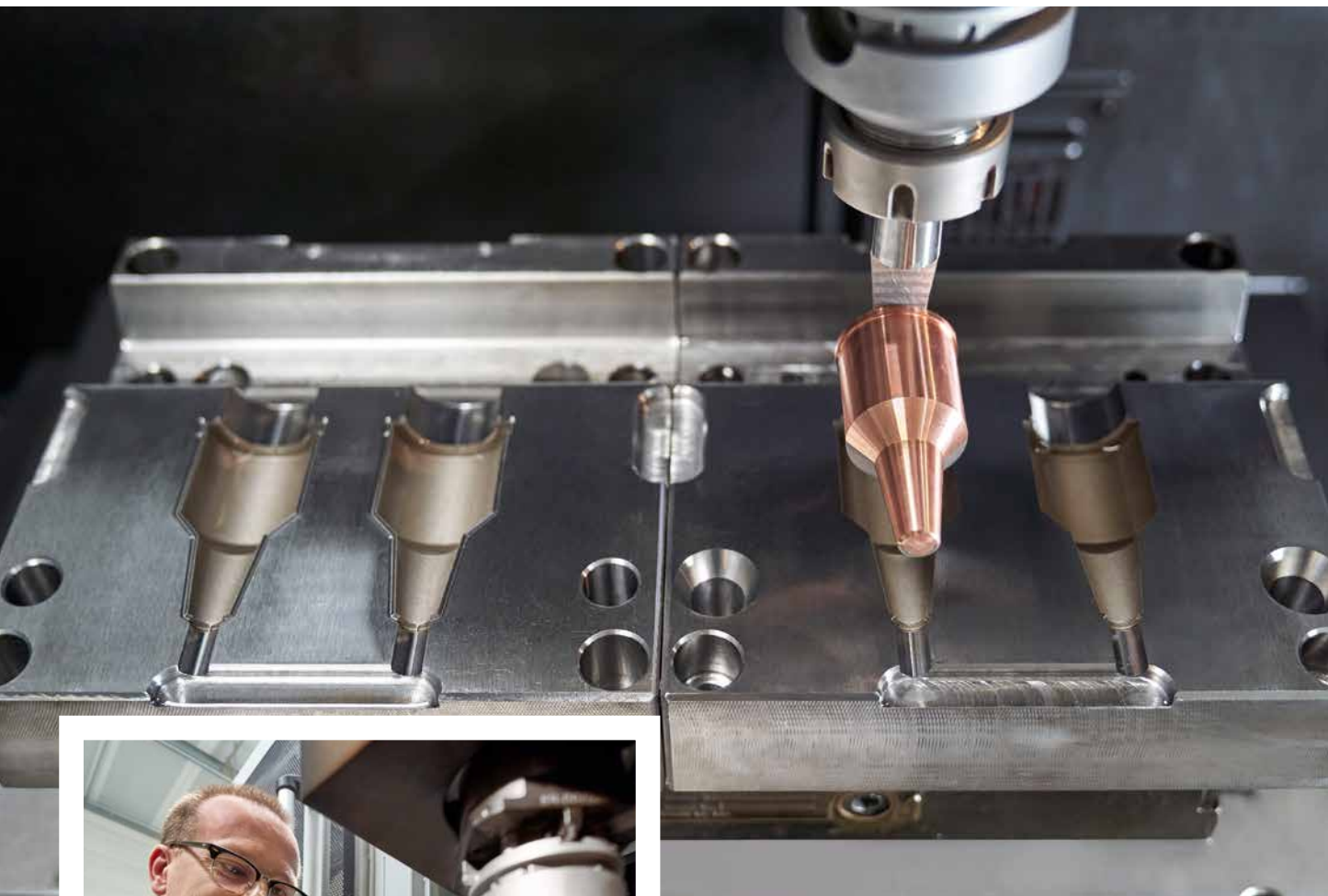
Stampo in gomma a 2 cavità – finitura ad erosione
