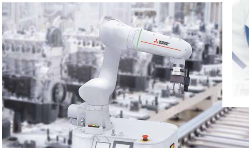
Le cobot MELFA Assista de Mitsubishi Electric est conçu pour une collaboration directe avec les opérateurs humains.
