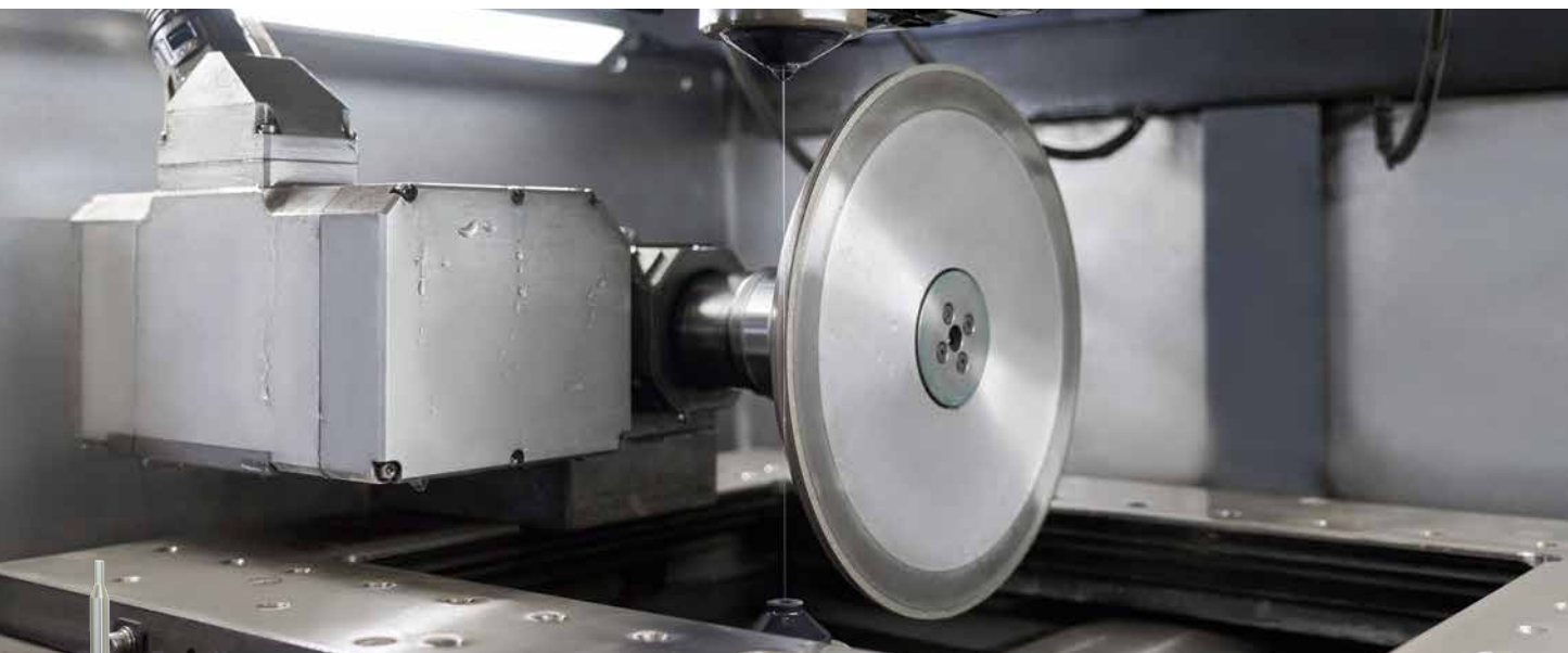
Espace de travail du système d'érosion à fil pour le profilage de meules diamantées
