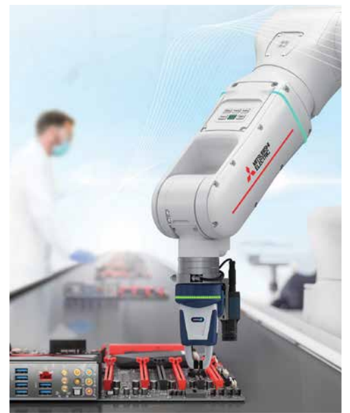
Le MELFA Assista est adapté à la manutention de petites charges pouvant aller jusqu'à 5 kg.
