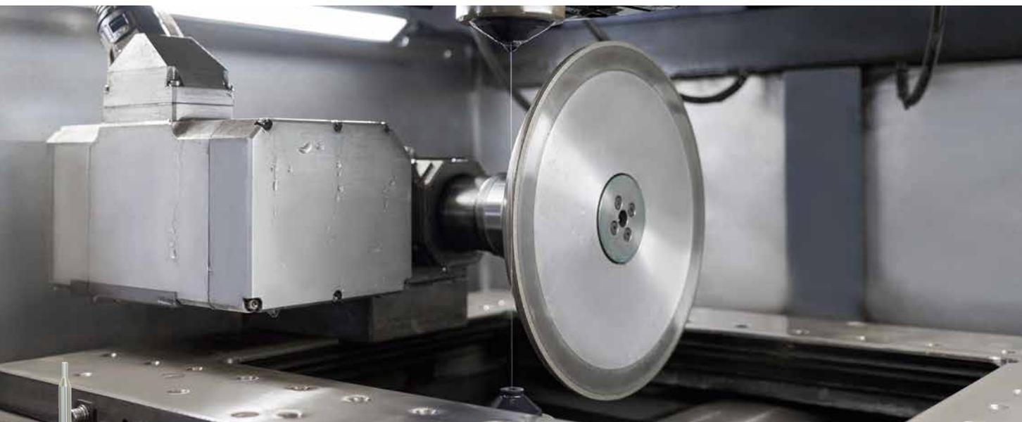
Area di lavoro della macchina ad elettroerosione a filo per la profilatura di mole
