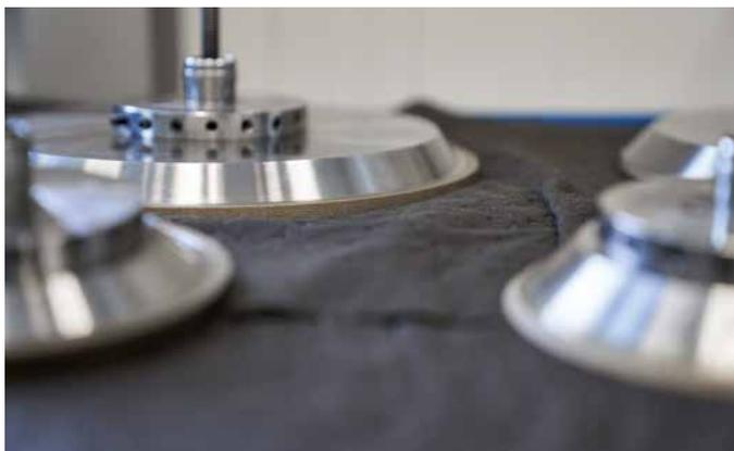
Mole diamantate prima del processo di erosione
