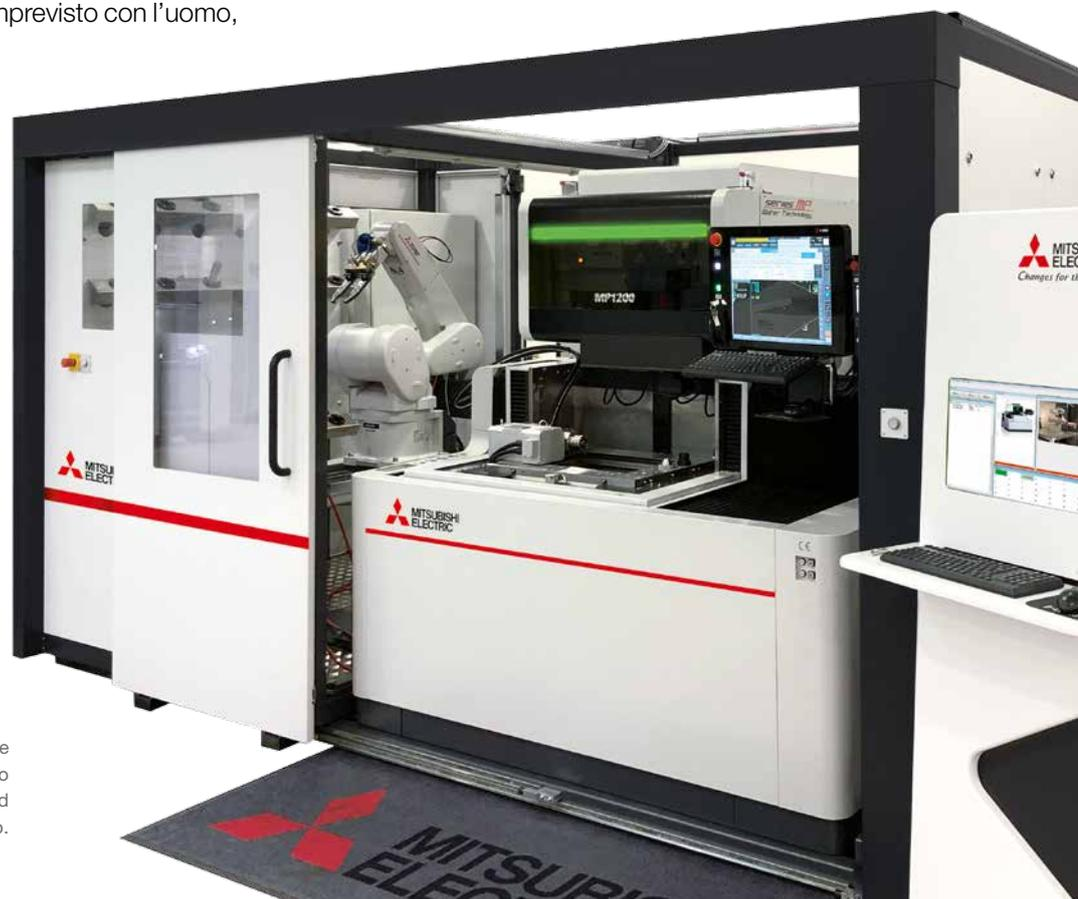
Nella DiamondCell, un robot industriale di Mitsubishi Electric gestisce l’ingresso e l’uscita delle mole dalle macchine ad elettroerosione a filo.
