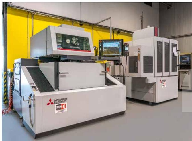
L'acquisto della macchina ad elettroerosione a filo NewGen MV1200S e dell'elettroerosione a tuffo EA12S ha segnato un grande passo avanti per l'azienda.
