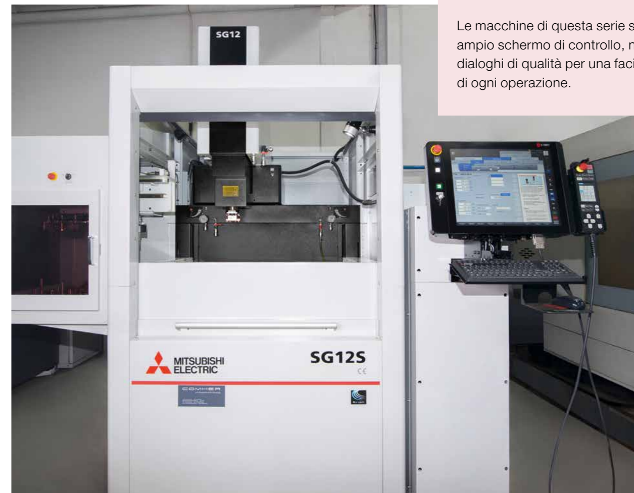
SG12S Macchina ad elettroerosione a tuffo Mitsubishi Electric. Design compatto e facile da usare.
