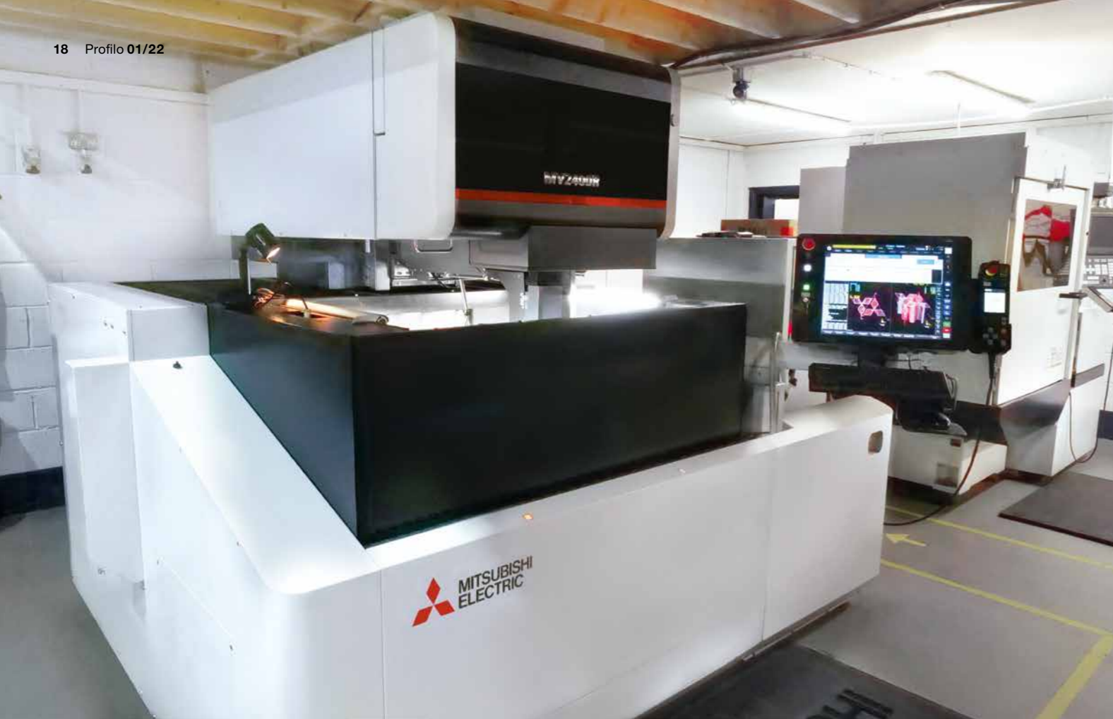
Le macchine sono dotate di scale lineari proprio accanto allo spazio di lavoro. Ciò consente la massima precisione.
