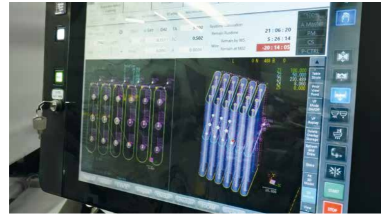
La nuova interfaccia utente con schermo tattile da 19 pollici offre una programmazione CAD/CAM integrata per ottimizzare il processo di lavoro.
