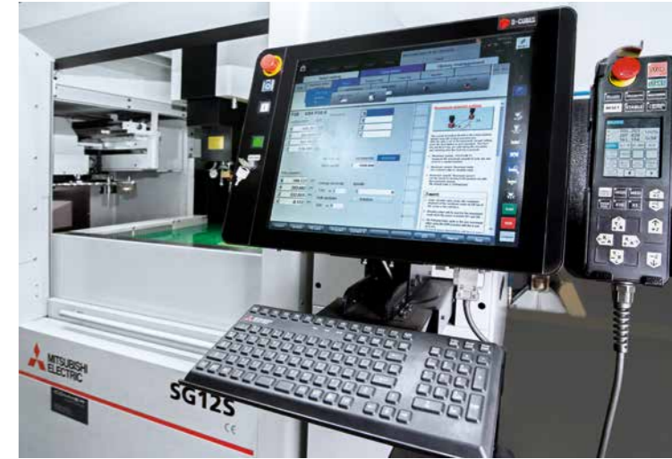
Con una guida dettagliata, gli utenti meno esperti possono imparare a controllare l'intero processo. Inoltre, l'intuitivo comando a mano facilita la regolazione della parte nella macchina.
