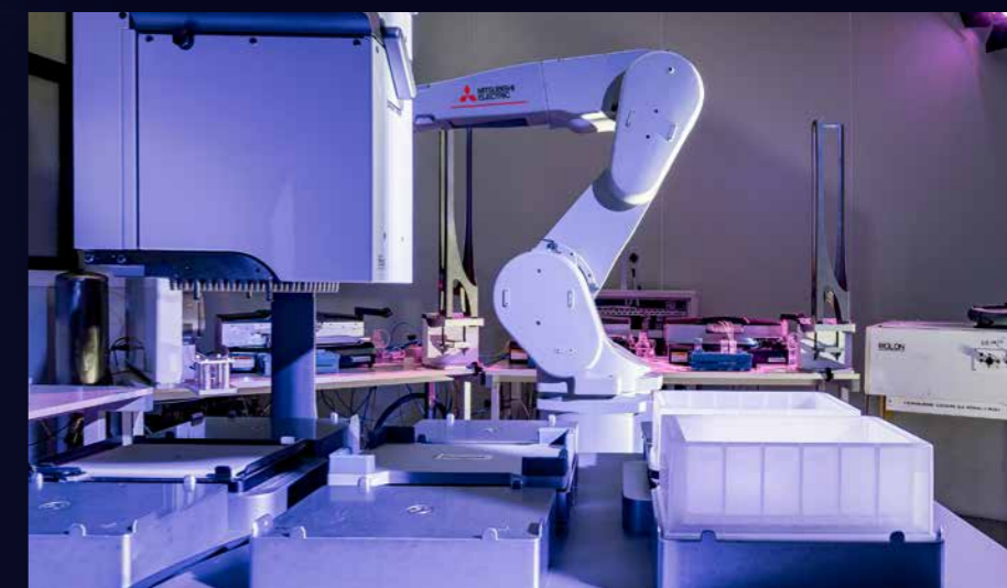
Il robot Mitsubishi Electric è il componente centrale del sistema. Gestisce continuamente l'apparecchiatura analitica sulla base delle specifiche, conducendo 15.000 test al giorno, 7 giorni alla settimana.
