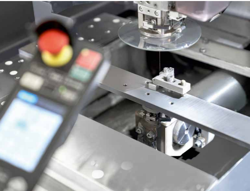
Un campione bloccato nello spazio di installazione dell'MV1200S NewGen poco prima dell'inizio del processo
