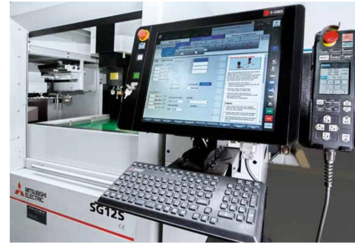
Grâce à un guidage pas à pas, les utilisateurs moins expérimentés peuvent malgré tout maîtriser un contrôle complet du processus. En outre, la commande manuelle intuitive permet de régler facilement la pièce dans la machine.
