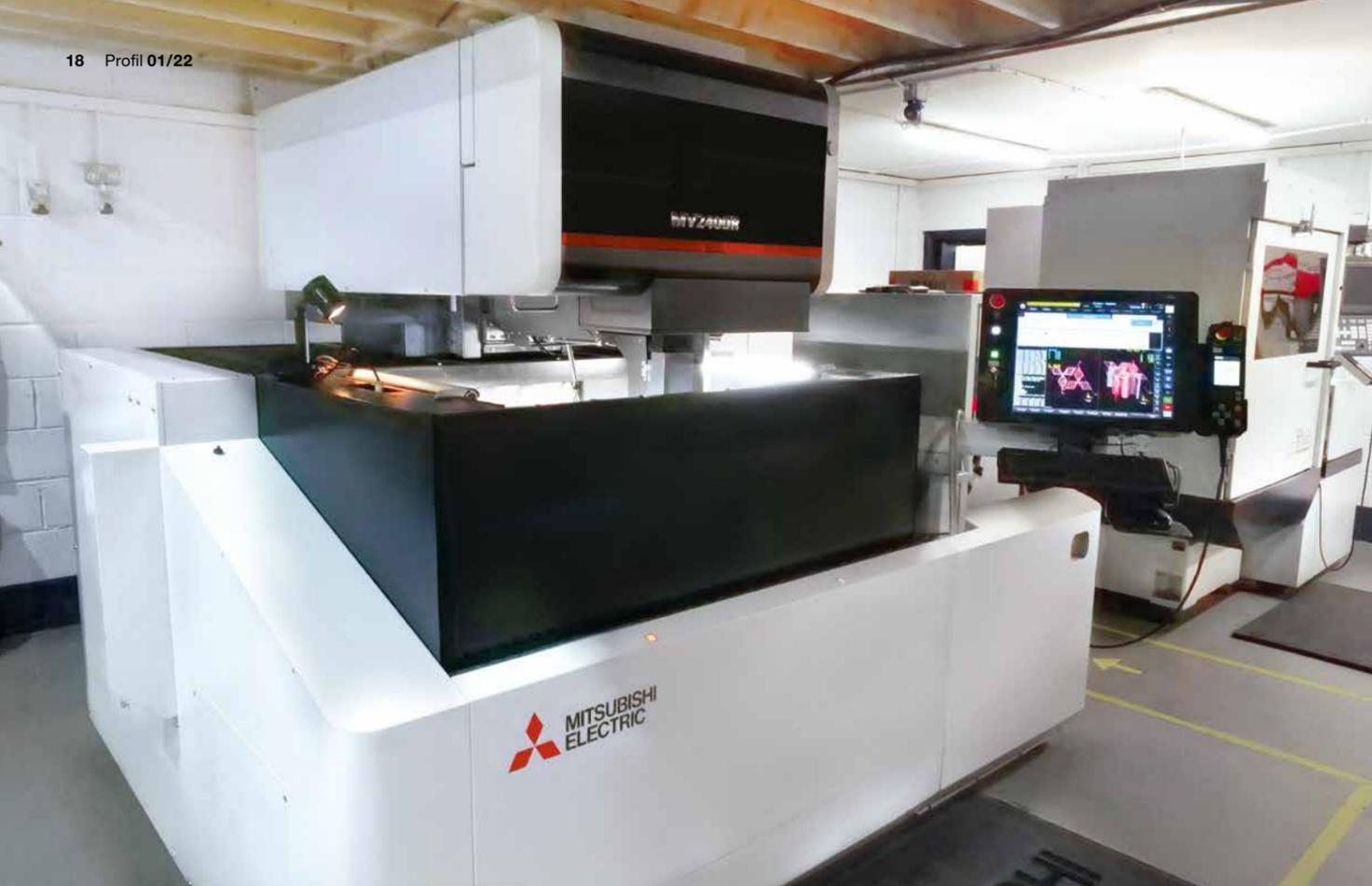
Les machines sont équipées de règles linéaires en verre placées proche de la zone de travail, afin de garantir une précision maximale aux utilisateurs.
