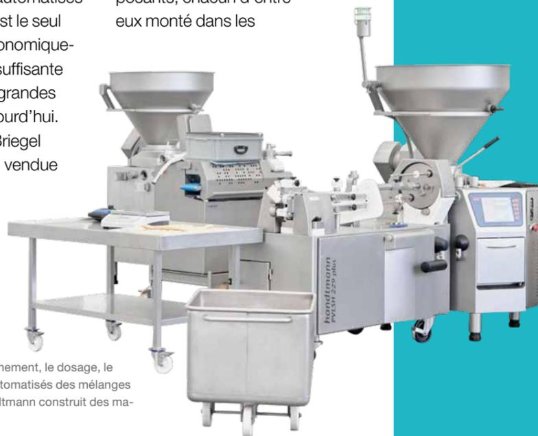
Pour l'alimentation, le portionnement, le dosage, le remplissage et l'emballage automatisés des mélanges de pâte et de saucisses, Handtmann construit des machines modulaires.
