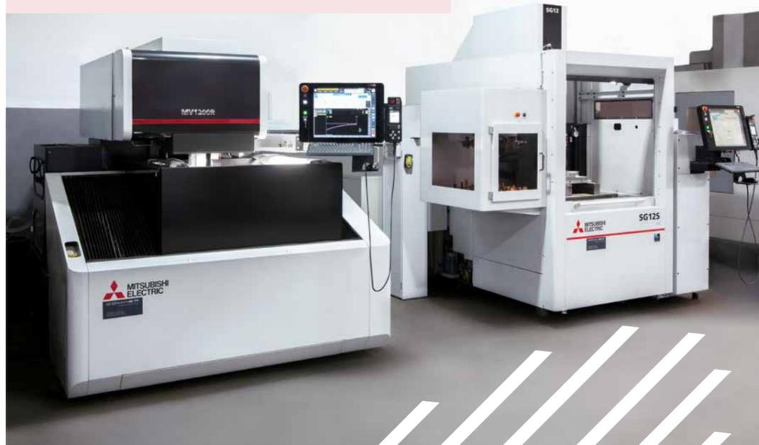
Une machine d'électroérosion à fil MV1200R Connect et une machine d'électroérosion par enfonçage SG12S, le duo parfait pour la section électroérosion de tout atelier.
