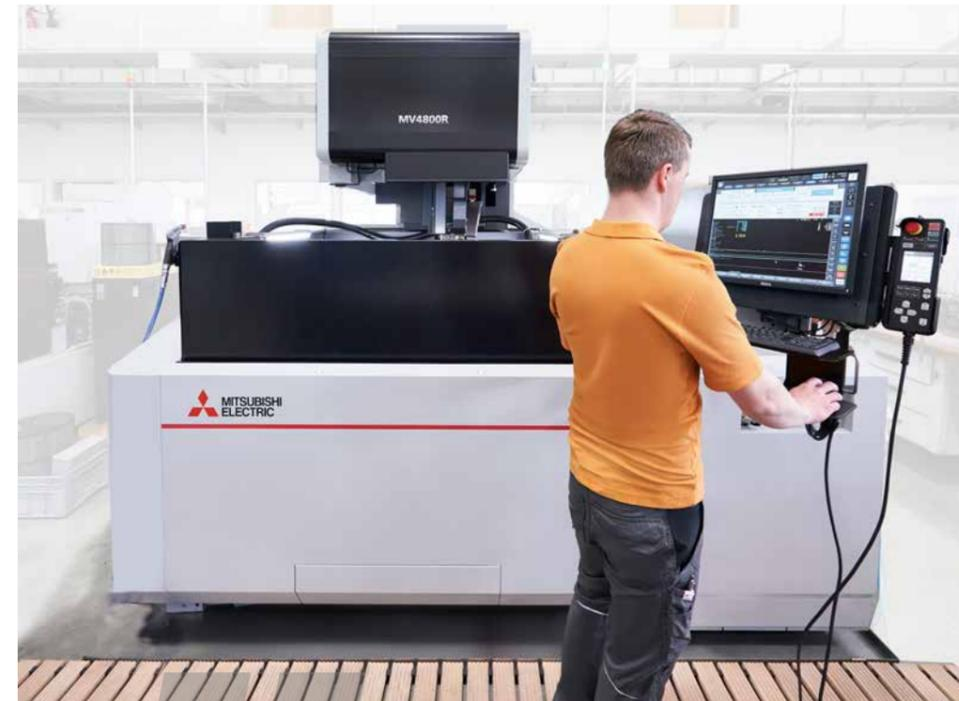
*De nombreux composants essentiels au fonctionnement de nos machines de remplissage et de portionnement ne peuvent être produits que par électroérosion à fil.*
