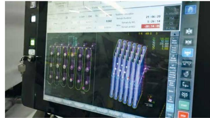
La nouvelle interface utilisateur équipée d'un écran tactile de 19 pouces offre une programmation intégrée de la CAO/FAO pour optimiser le processus de travail.
