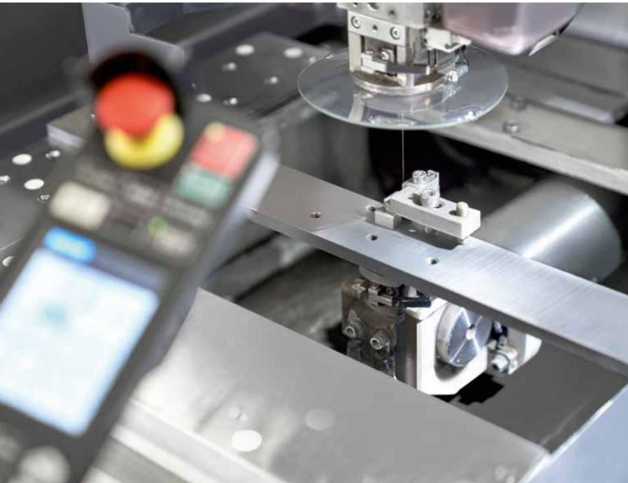
Une éprouvette bridée sur la table de travail de la MV1200S NewGen avant usinage
