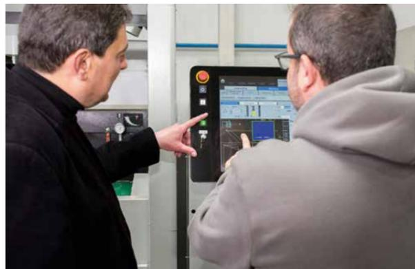
NUI - Interface utilisateur naturelle. L'écran tactile ressemble à celui d'un smartphone, ce qui permet de naviguer facilement entre les différents écrans.
