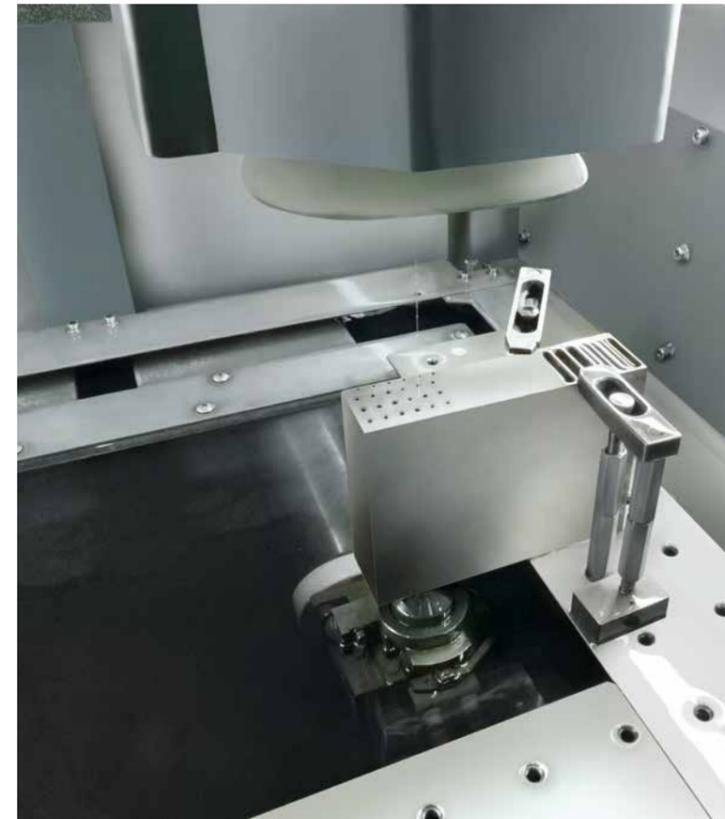
Capable d'usiner tous les matériaux, du graphite au PCD, avec une grande précision.
