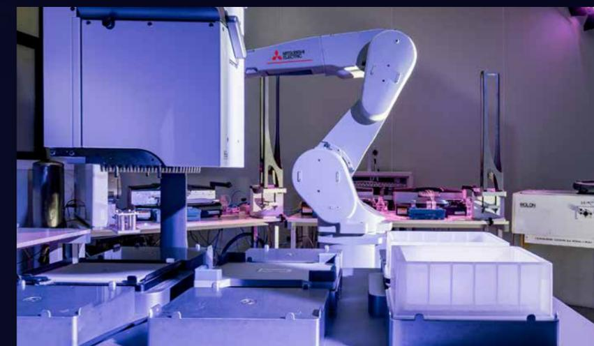
Le robot Mitsubishi Electric est l'élément central du système. Il fait fonctionner en permanence les équipements d'analyse sur la base de spécifications, réalisant 15 000 tests par jour, 7 jours sur 7.
