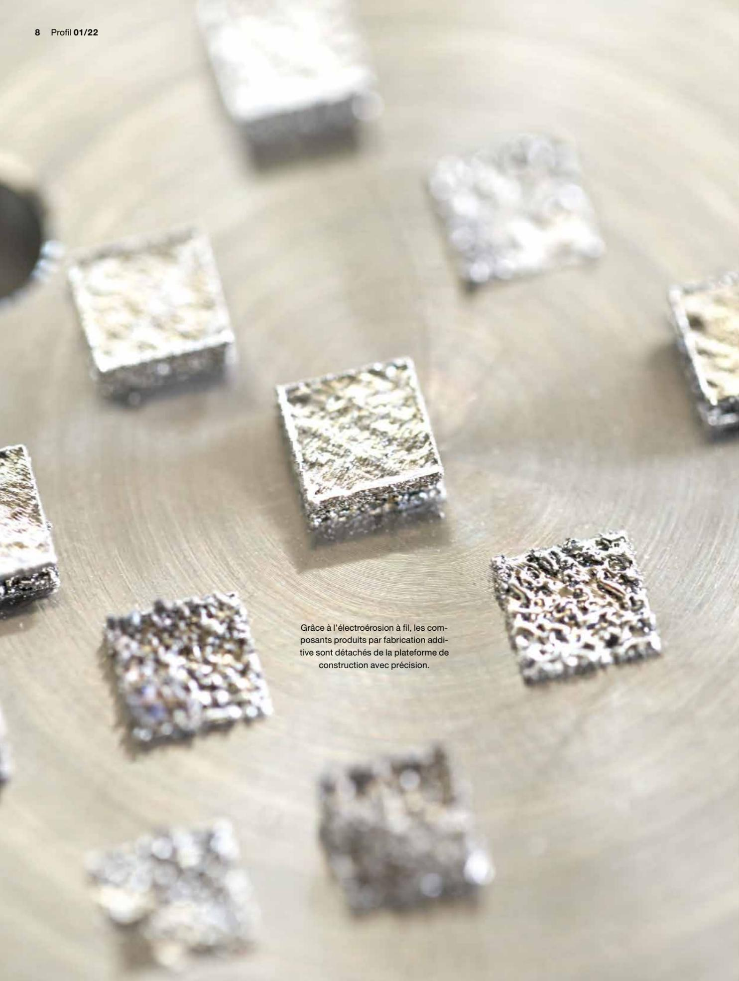
Grâce à l'électroérosion à fil, les composants produits par fabrication additive sont détachés de la plateforme de construction avec précision.
