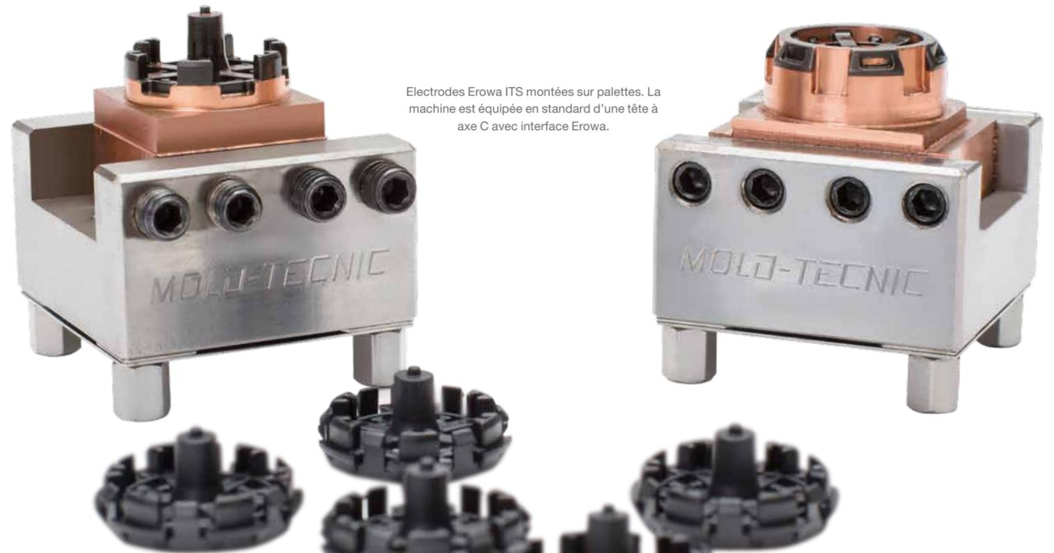
Electrodes Erowa ITS montées sur palettes. La machine est équipée en standard d'une tête à axe C avec interface Erowa.
