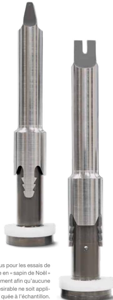
Des montages spécialement conçus pour les essais de propagation de fissures. La structure en « sapin de Noël » est libre de se déplacer latéralement afin qu'aucune composante de force latérale indésirable ne soit appliquée à l'échantillon.
