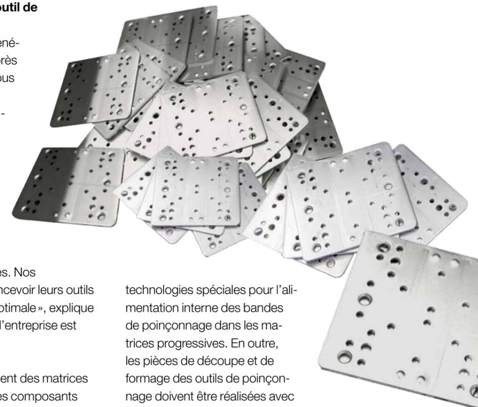
technologies spéciales pour l'alimentation interne des bandes de poinçonnage dans les matrices progressives. En outre, les pièces de découpe et de formage des outils de poinçonnage doivent être réalisées avec une grande précision et une qualité de surface très élevée », ajoute-t-il.
