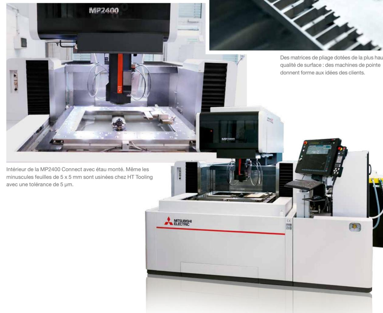
Intérieur de la MP2400 Connect avec étau monté. Même les minuscules feuilles de 5 x 5 mm sont usinées chez HT Tooling avec une tolérance de 5 µm.
