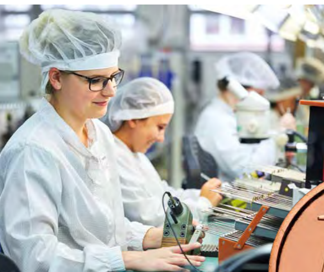
Geprüft und montiert werden die Präzisionswälzlager im Reinraum.
