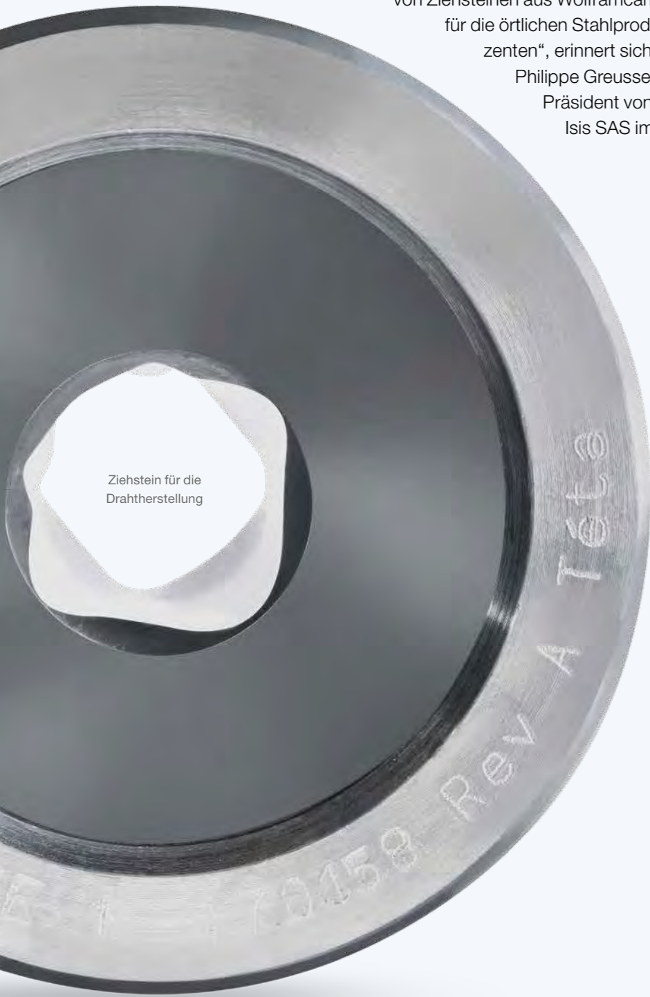
Schnittbild eines Ziehsteins für die Drahtherstellung. Der Draht wird vorne angespitzt, durch die Öffnung gesteckt und dann kontinuierlich hindurchgezogen. Beim Passieren gestufter Ziehsteine wird er immer dünner und länger.
