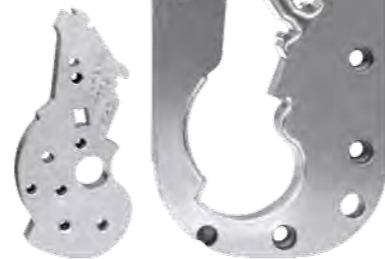
Stempel und Matrize für ein Blechteil werden mittels Drahterosion aus mehrere Zentimeter dickem, gehärtetem Werkzeugstahl geschnitten.
