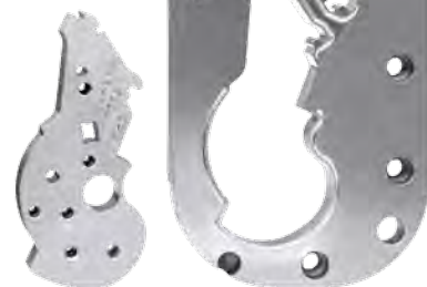
Il punzone e lo stampo per una parte di lamiera vengono tagliati mediante elettroerosione a filo da acciaio temprato per utensili di diversi centimetri di spessore.
