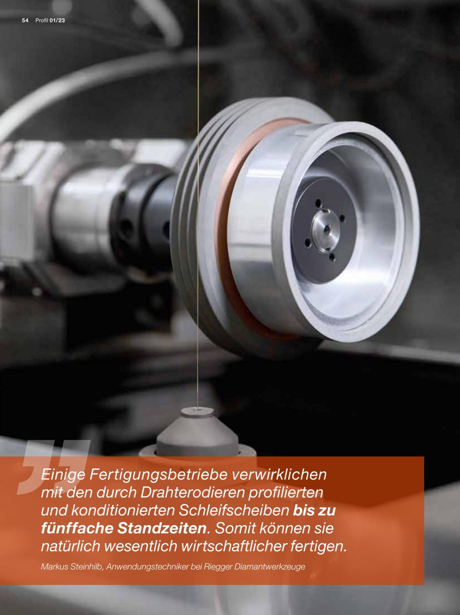
Einige Fertigungsbetriebe verwirklichen mit den durch Drahterodieren profilierten und konditionierten Schleifscheiben **bis zu fünffache Standzeiten**. Somit können sie natürlich wesentlich wirtschaftlicher fertigen.
