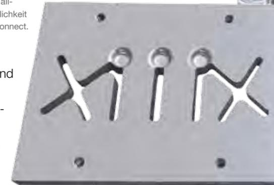
Minimalistisch: Um Prototypen oder kleine Vorserien zu produzieren, genügen häufig einfachste Stanz- und Umformwerkzeuge.
