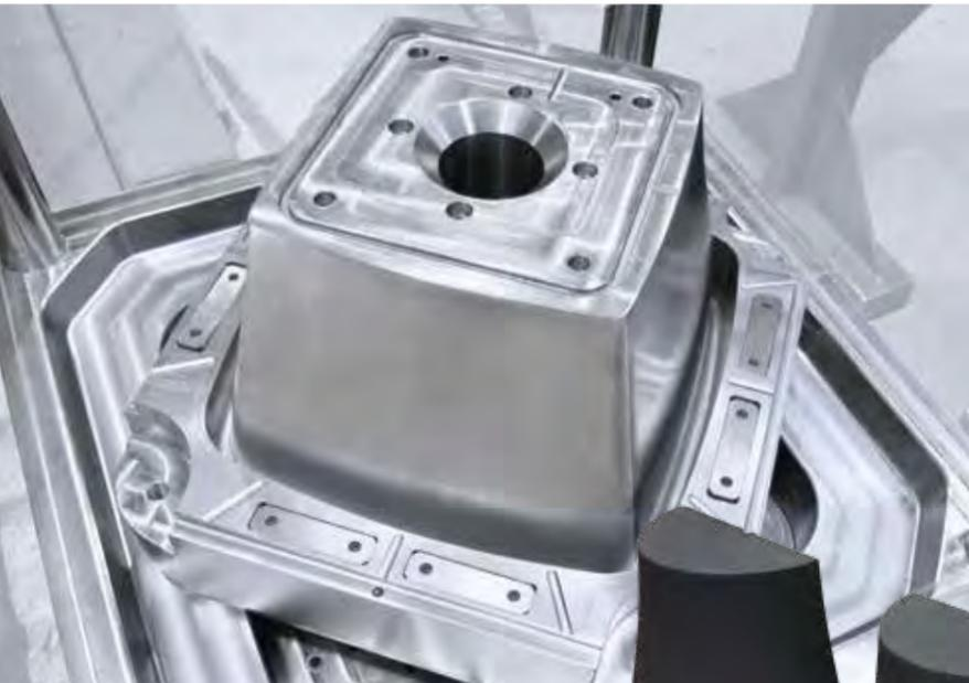
Die Fertigung ist für eine Werkzeuggröße von 1000 x 1000 mm ausgelegt.
