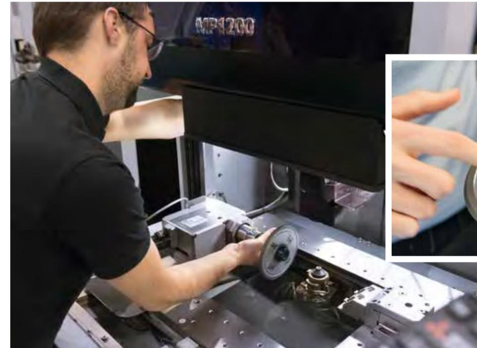
Profilierte Schleifscheibe mit DataMatrix-Code
