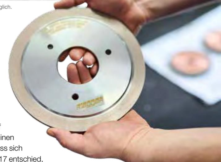
Solide Basis: Individuell profilieren die Spezialisten bei Riegger mit Diamant oder CBN gebundene Standard-Schleifscheiben.
