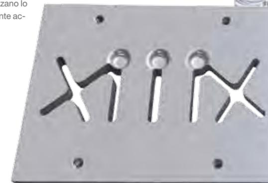
Approccio minimalista. Per produrre prototipi o piccole serie pilota, sono spesso sufficienti gli utensili di punzonatura e sagomatura.
