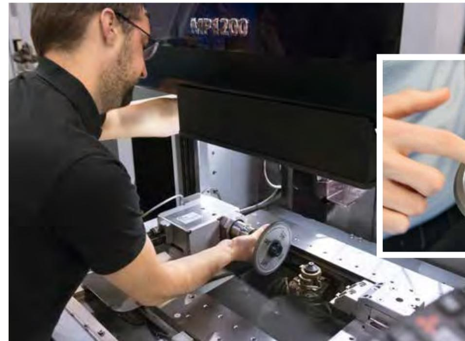
Fissaggio della mola nel mandrino ITS nell'ampio spazio di lavoro della MP1200 Connect
