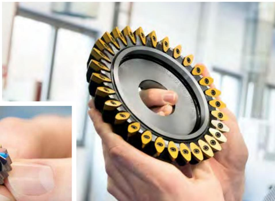
Utilizzando inserti in metallo duro, è possibile ottenere grandi volumi di taglio ad alte velocità.
