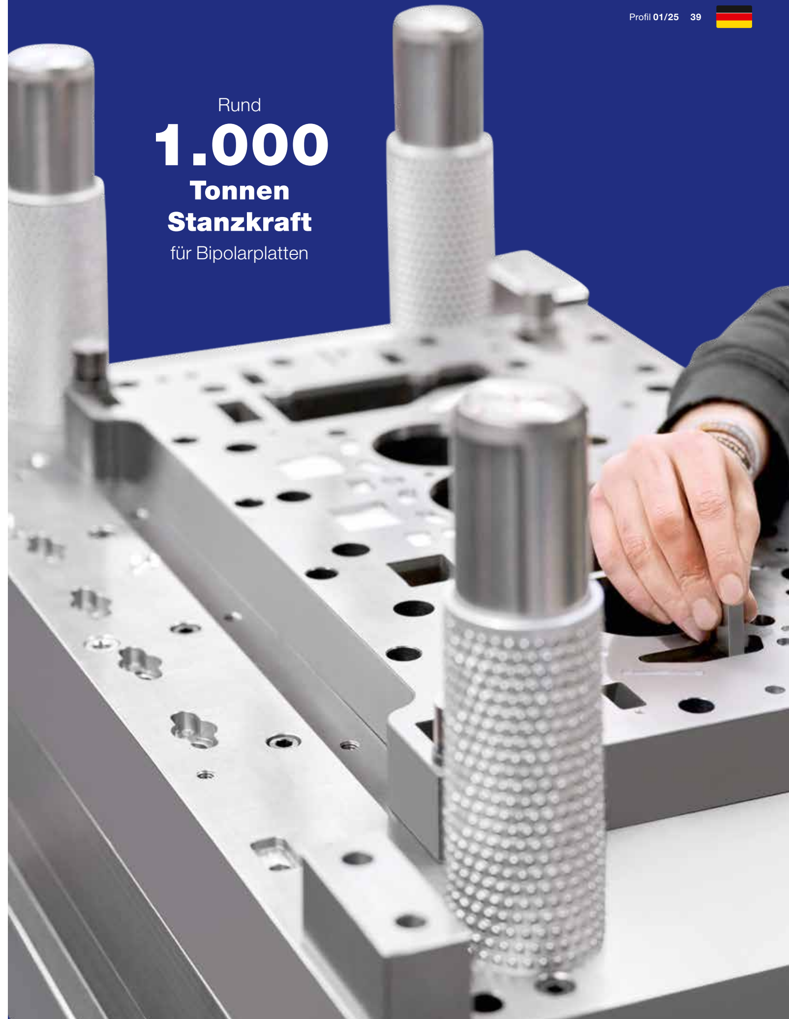
Zwei Folgeverbundwerkzeuge in Stirnansicht
