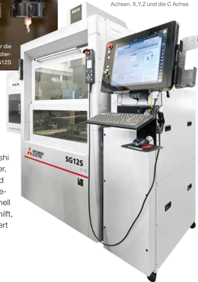
Die Senkerodiermaschine Mitsubishi SG12S verfügt über 4 Achsen. X,Y,Z und die C Achse
