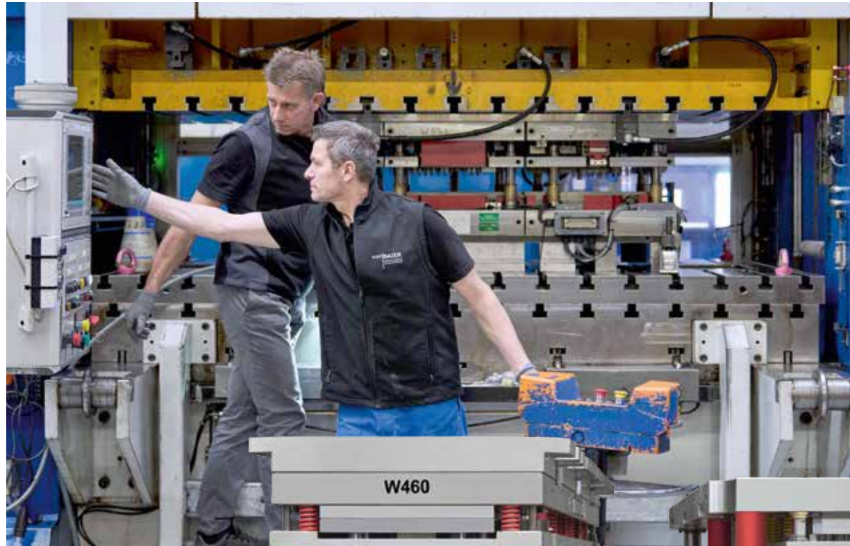
Einstellarbeiten an einem komplexen Folgeverbundwerkzeug
