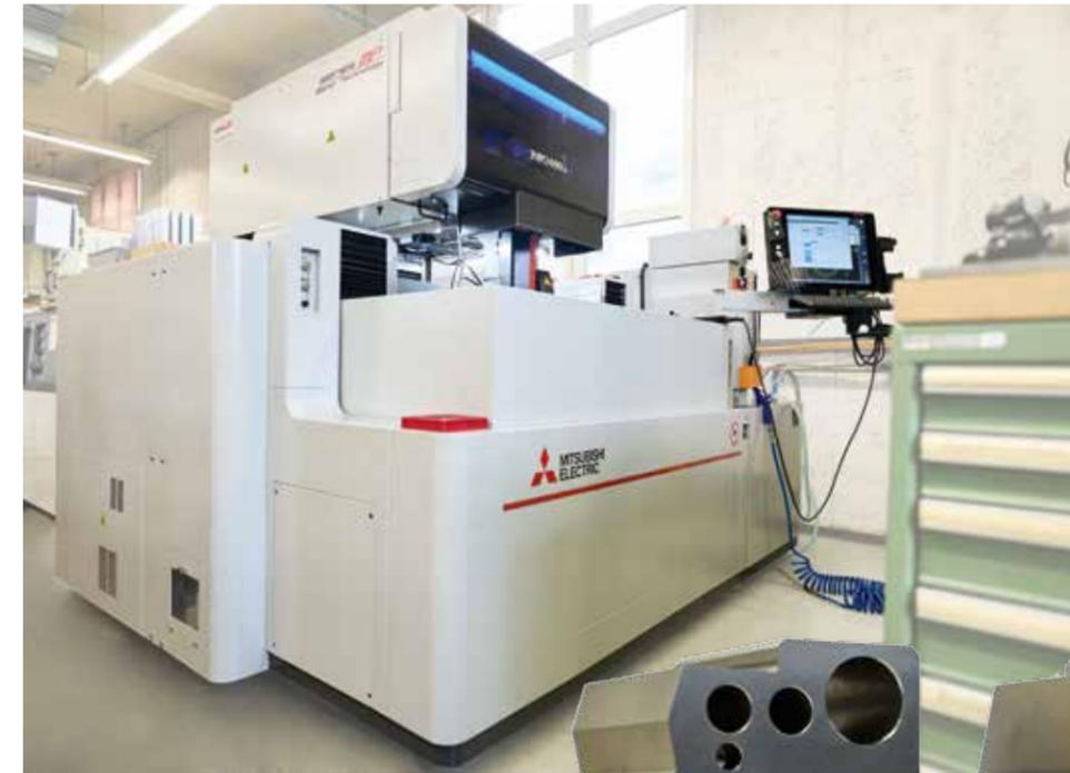
La dernière acquisition dans le domaine de l'électroérosion à fil est la machine de haute précision MP2400 Connect
