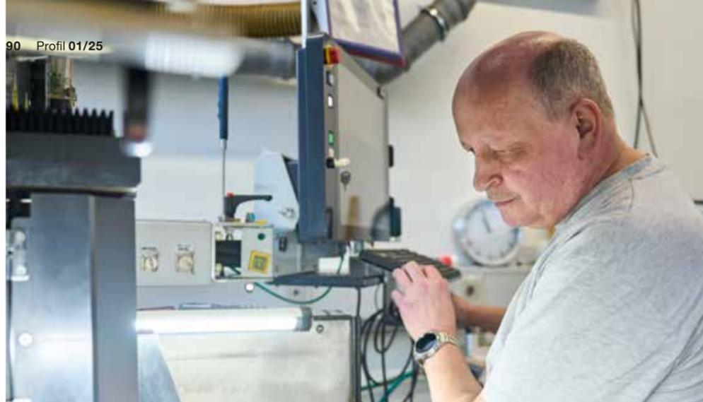
Hautement concentré : Bruno Bon à la commande d'une machine d'électroérosion à fil Mitsubishi Electric MV1200R Connect
