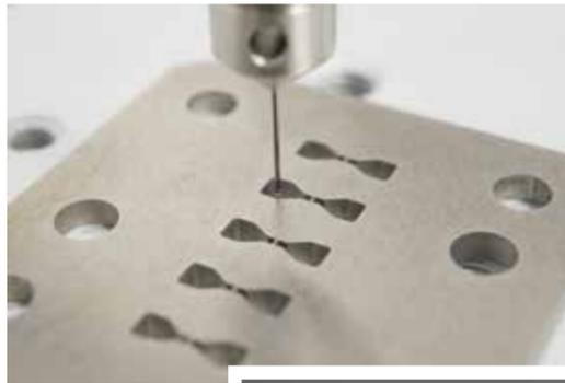
Même les plus petites cavités peuvent être mesurées grâce aux palpeurs de mesure avancés et aux machines de mesure tridimensionnelles.
