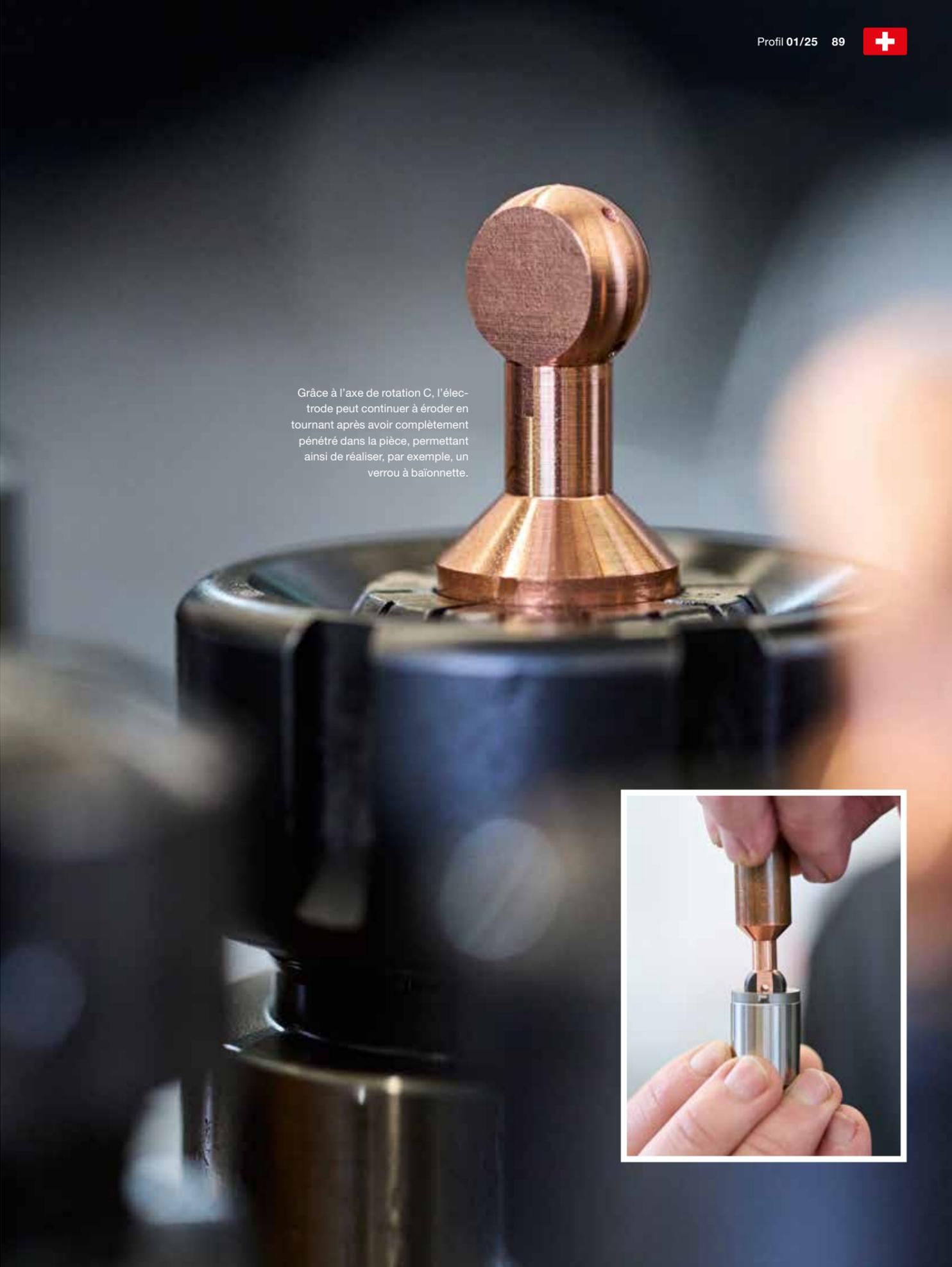
Grâce à l'axe de rotation C, l'électrode peut continuer à éroder en tournant après avoir complètement pénétré dans la pièce, permettant ainsi de réaliser, par exemple, un verrou à baïonnette.
