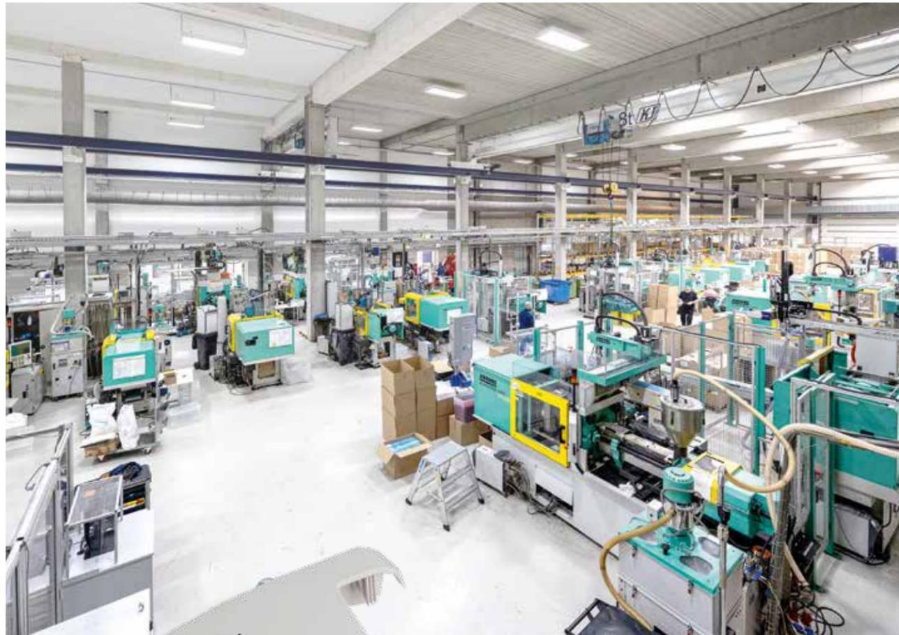
Des distances courtes : les machines de moulage par injection, dans lesquelles les moules fabriqués par Dreuco sont utilisés, se trouvent un étage plus bas.
