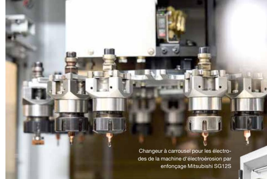
Changeur à carrousel pour les électrodes de la machine d'électroérosion par enfonçage Mitsubishi SG12S
