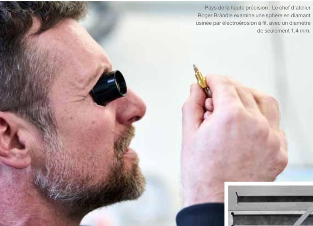
Pays de la haute précision : Le chef d'atelier Roger Brändle examine une sphère en diamant usinée par électroérosion à fil, avec un diamètre de seulement 1,4 mm.
