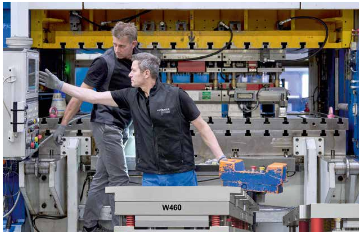
Lavori di regolazione su un complesso utensile a passo progressivo
