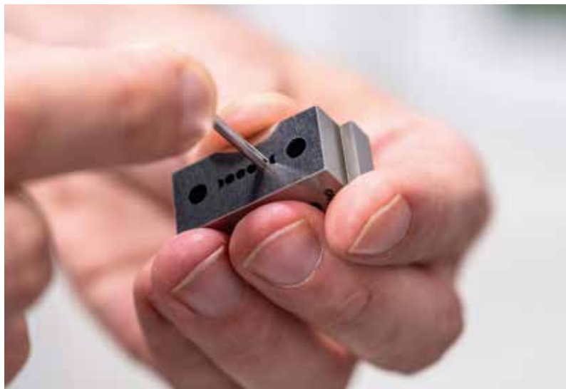
Per le macchine per elettroerosione a filo, utilizziamo un approccio giapponese con utensili molto piccoli e una tolleranza di 1-2 millesimi, per ottenere il miglior accoppiamento possibile.
